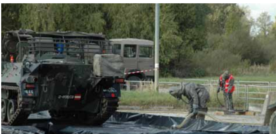
Die Dekontamination von Kettenfahrzeugen
